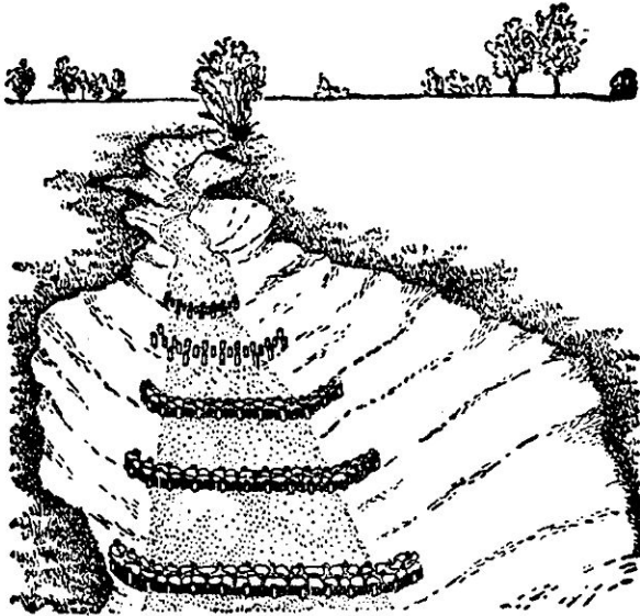
Represas en serie para evitar el avance de erosión profunda
